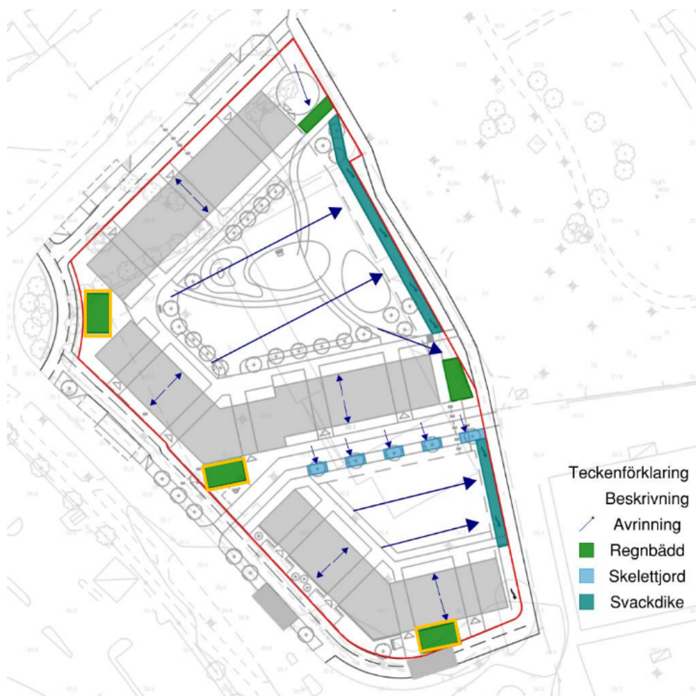
Bild 25. Åtgärdsförslag enligt dagvattenutredningen (Bjerking, 2022). Regnbäddar med gul markering redovisar den totala ytan som behövs, regnbäddarna kan delas upp i mindre regnbäddar jämnt fördelat på förgårdsmarken.
