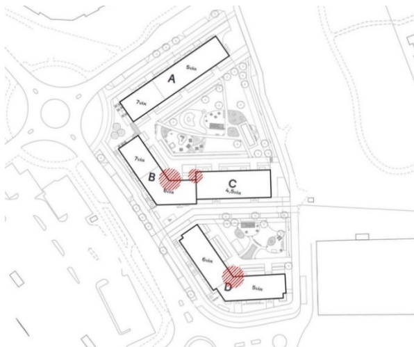
Bild 29. Illustrationen visar de lägen, rödmarkerade ytor, som kan vara kritiska för att uppnå kraven på dagsljus. Bild Krook & Tjäder.
