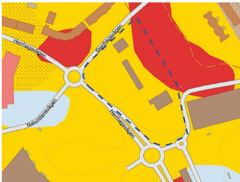
Bild 22. Utsnitt ur SGU:S jordartskartering. Planområde markerat med blå streckad linje. Gul färg indikerar glacial lera, röd färg indikerar urberg.
